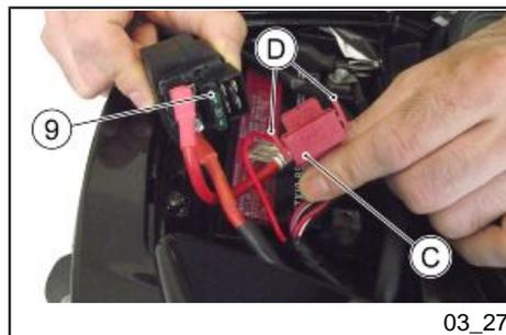
Working on the side fins «D», remove the cover «C» to access the main fuse «9».
